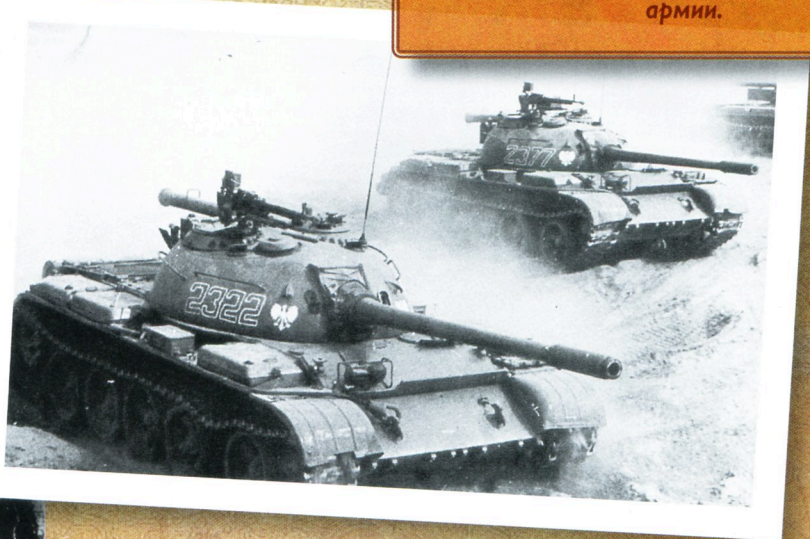
★ Средний танк Т-54-3 Советской армии с установленным над стволом пушки лазерным дальномером КДТ-1.
